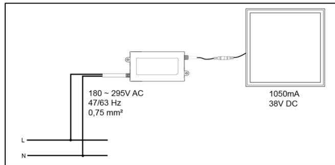
**C. Anschluss dim 1-10V**
