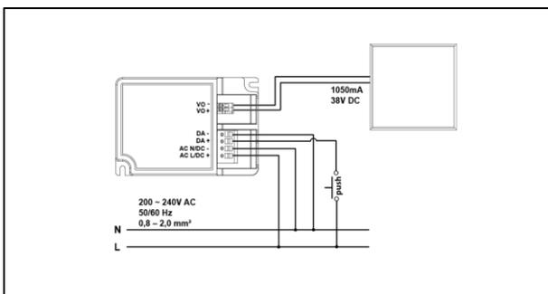
**F. Anschluss 1050mA LED-Betriebsgerät**
