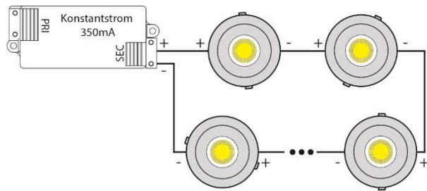
\*Schließen Sie die Leuchte nicht an ein eingeschaltetes LED-Betriebsgeräte an. Einige LED-Betriebsgeräte geben im Leerlauf eine hohe Spannung ab, was zu einer dauerhaften Beschädigung der Leuchte führen kann. Trennen Sie den LED-Betriebsgeräte unbedingt von der Netzleitung, bevor Sie die Leuchte anschließen.
